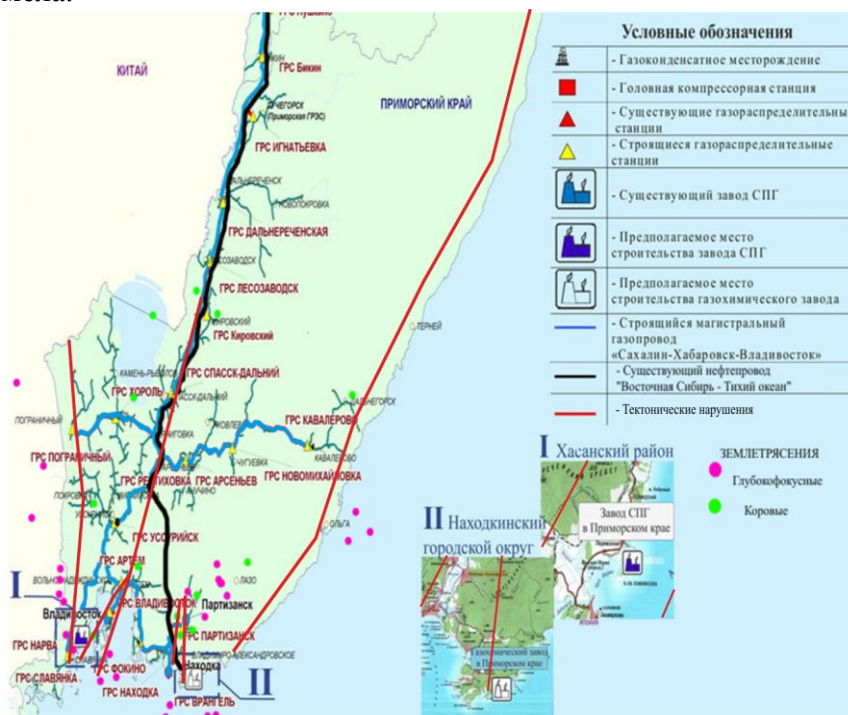
Рис.1 Схема сеймотектонической активности вблизи трасс газонефтепровода.
