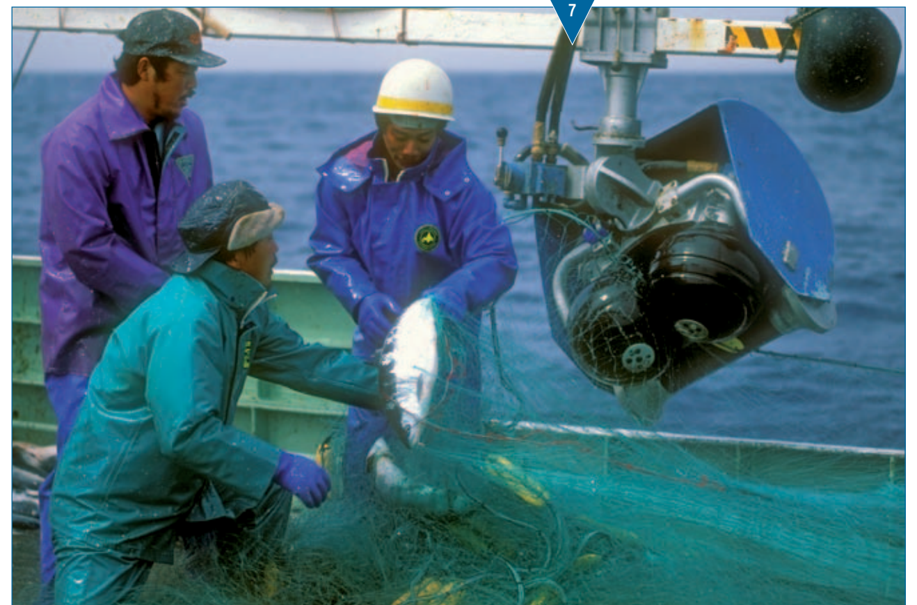
Рис. 7. Выборочная лебедка верхней подборы дрейферного порядка
