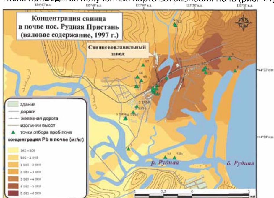
Рис. 14. Пространственная интерполяция загрязнения почв методом кригинга, по данным валового содержания свинца, 1996-1997 гг.
