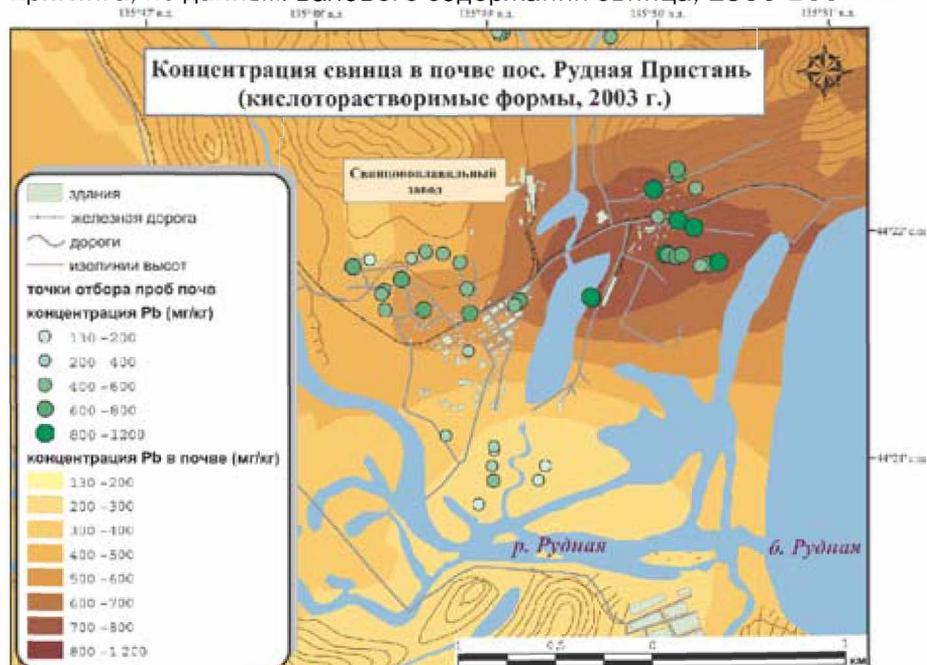
Рис. 15. Пространственная интерполяция загрязнения почв свинцом
