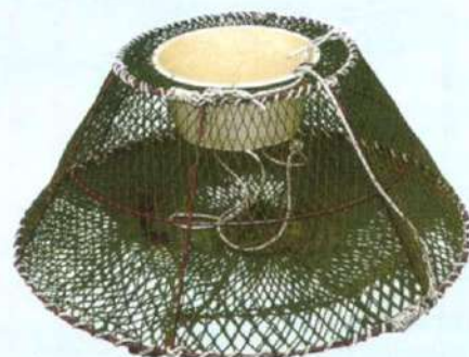
Рис. 219. Крабовая ловушка (1500 мм x 750 мм x 650 мм)
