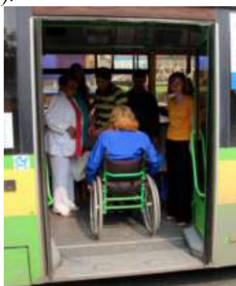
Рисунок 53 – Отсутствие площадки для представителя МГН в подвижном составе
