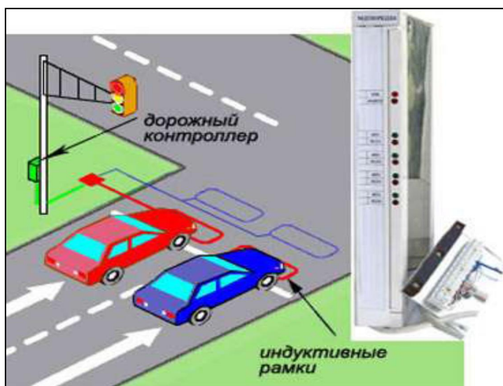
Рисунок 37 – Механизм работы электромагнитного детектора
