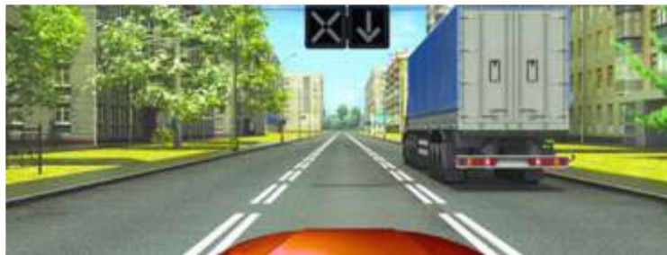
Рисунок 27 – Разметка 1.9 (полоса для реверсивного движения)
