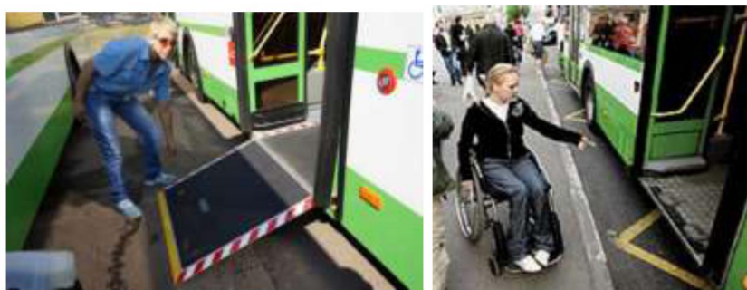
Рисунок 52– Зазор между транспортным средством и бортовым камнем остановочного пункта
