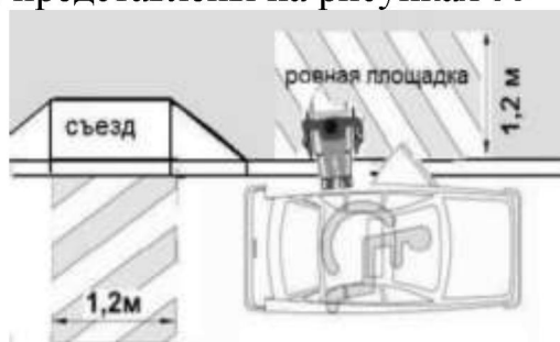
Рисунок 55 – Типовое оборудование парковочного места для МГН параллельно проезжей части
