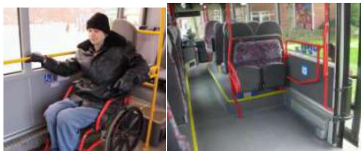
Рисунок 54– Оборудование подвижного состава для комфортного перемещения МГН
