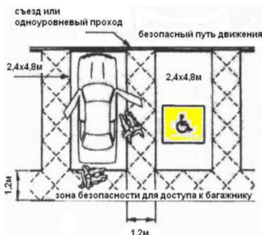
Рисунок 56 – Типовое оборудование парковочного места для МГН перпендикулярно проезжей части
