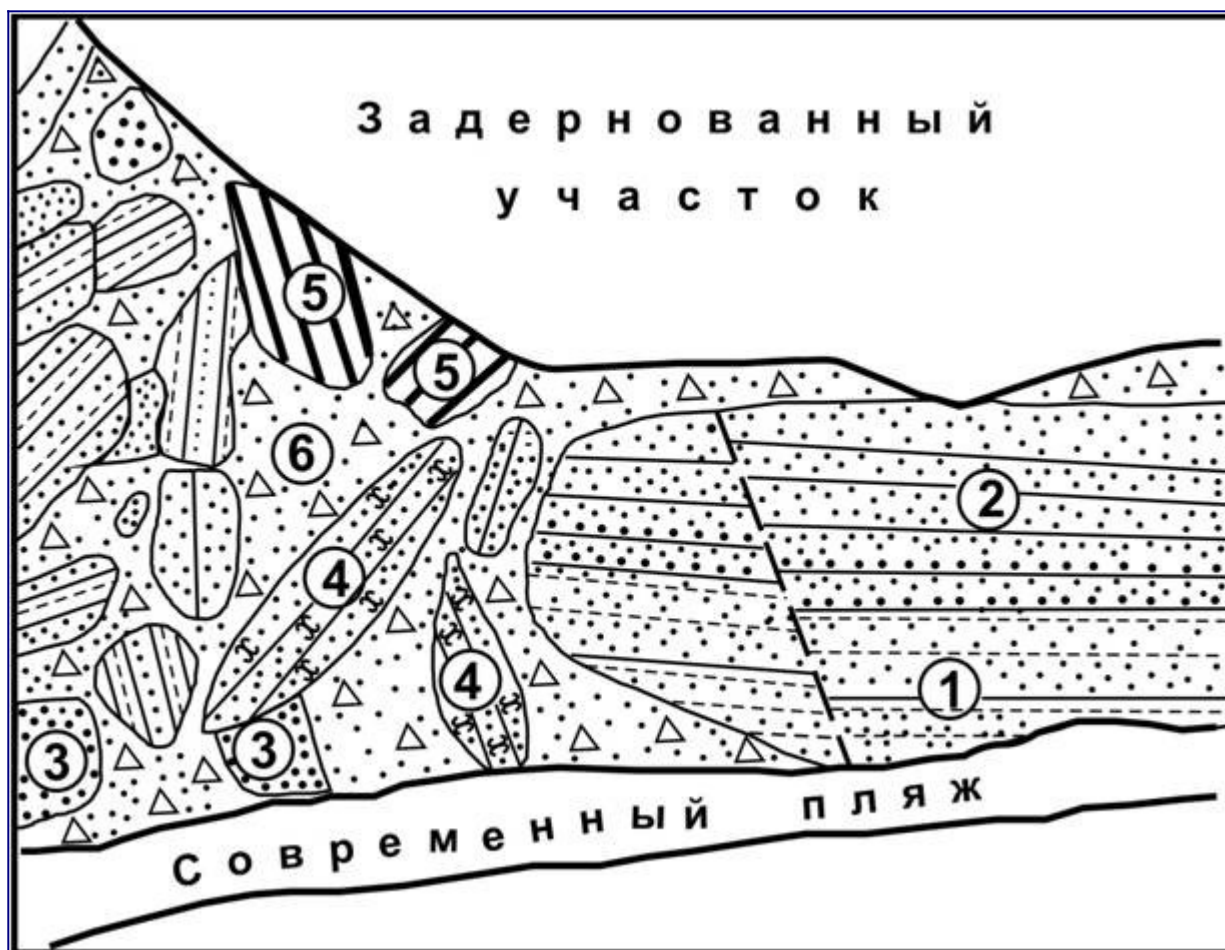
Рис. 4. Деталь строения гигантбрекчий: 1. – переслаивание туфоалевролитов и туфопесчаников; 2- переслаивание туфопесчаников и известковых туффитов; 3 – гравелиты; 4 – известковистые песчаники; 5 – туфоалевролиты и туфоаргиллиты; 6 – брекчии [8].
