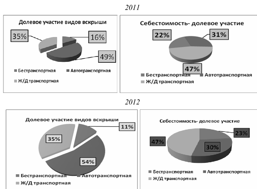
Рис. 3. Характер изменения объемов вскрышных работ и затрат на их производство для различных видов вскрыши
