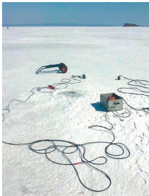
Рис. 2.16. Варианты постановки термогирлянды с ледового покрова (а), термогирлянда на льду Амурского залива перед постановкой (б)
