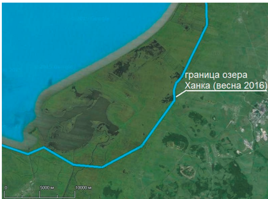
Рис. 2.27. Границы оз. Ханка весна 2016 г., установленные с помощью аэрофотосъемки малым летательным аппаратом DJI phantom 2
