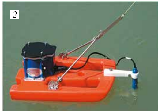
Рис. 1.86. Акустические профилографы Rio Grande (1) и Stream Pro (2) Фото с сайта http://tech.meteorf.ru
