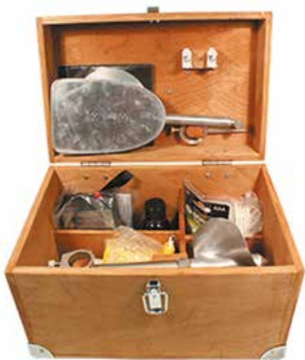
Рис. 1.81. Упаковочный ящик с сигнальным устройством и вертушкой ГР-21М в транспортном положении
