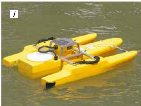
Рис. 1.86. Акустические профилографы Rio Grande (1) и Stream Pro (2) Фото с сайта http://tech.meteorf.ru
