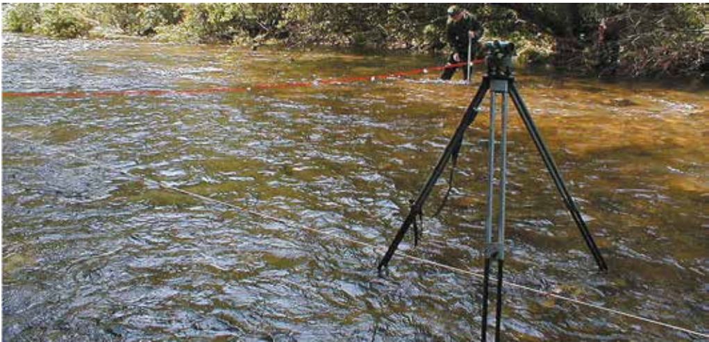
Рис. 1.71. Выполнение промеров глубин на участке р. Кедровая (заповедник «Кедровая Падь», Приморский край). Белая линия обозначает опорный створ, красная – промерный створ. Фото А. Федоровского
