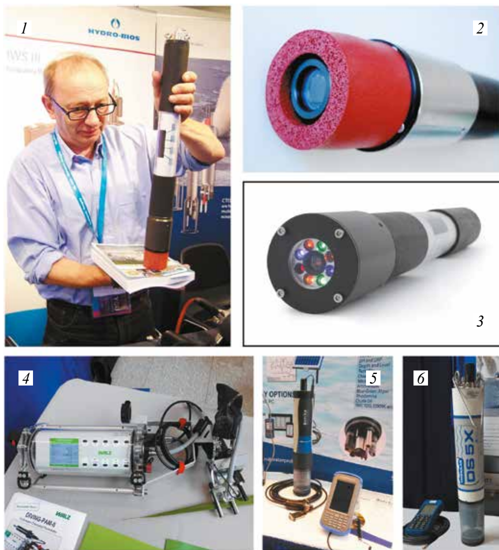
Рис. 2.32. Водные флуориметры и зонды: 1, 2 – донный фонарь (BenthosTorch), фото В. Богатова; 3 – водорослевый фонарь (Bbe AlgaeTorch), из: http://www.bbe-moldaenke.de/en/products/chlorophyll/details/algaetorch.html ; 4 – подводный флуориметр «DIVING-PAM-II»; 5 – водный зонд «Manta+30»; 6 – гидролабораторный зонд «DataSonde 5X-DS5X».
