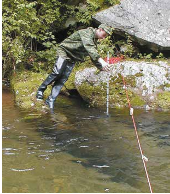
Рис. 1.77. Производство измерений глубин водомерной рейкой. Фото А. Федоровского
