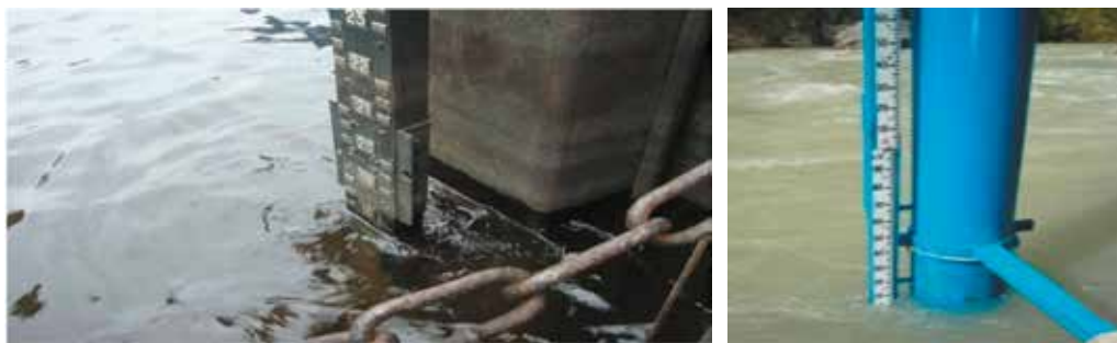
Рис. 1.74. Водомерные рейки. Фото с сайта http://www.meteo.nw.ru/articles/index.php?id=557 ; http://spox.ru/ru/termins/1374/vodomerniy_p.html
