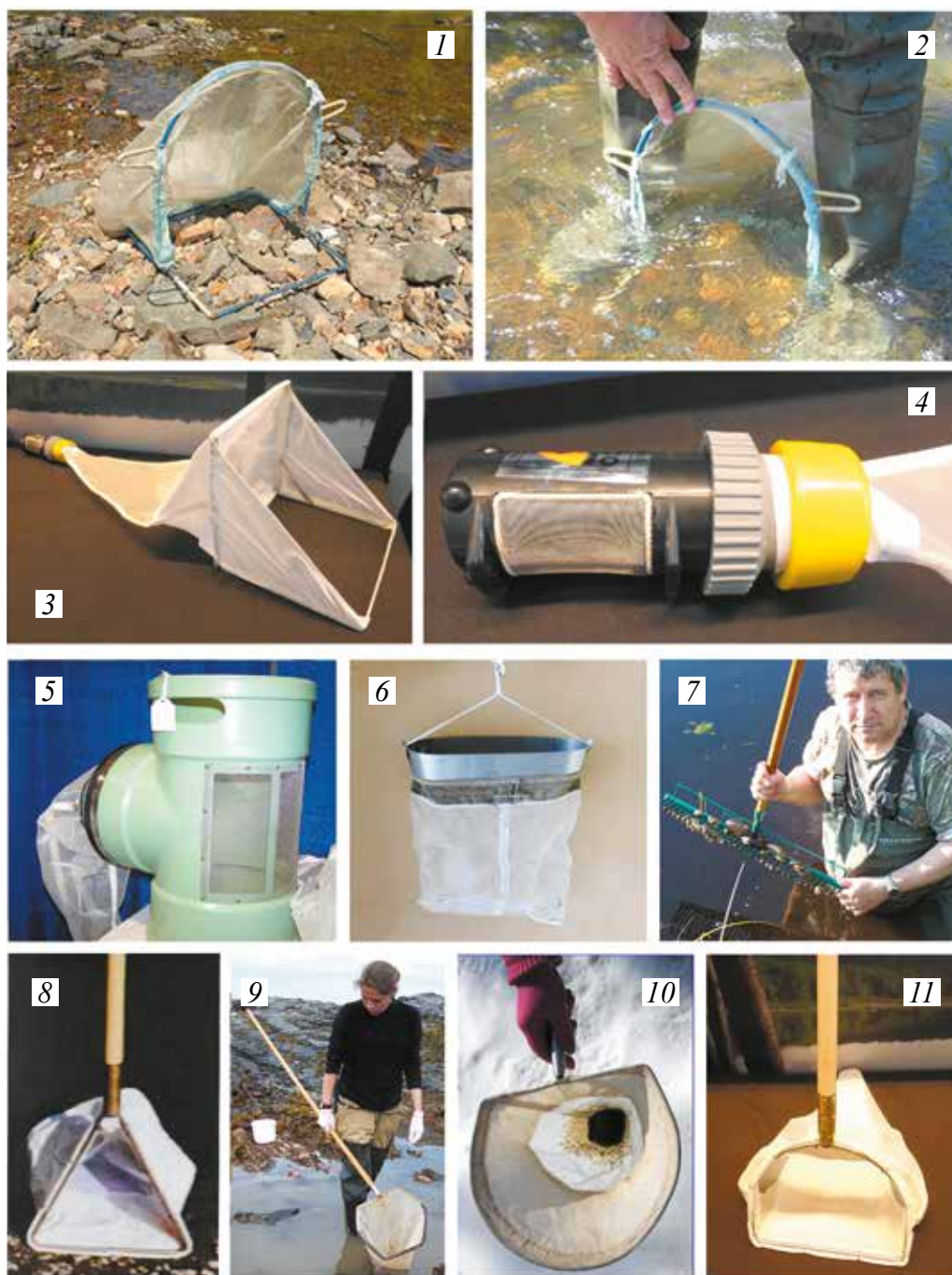
Рис. 2.27. 1–3 – складные бентометры; 4 – пластиковый стакан-камера; 5 – цилиндрический бентометр; 6 – закидная драга; 7 – сбор моллюсков с помощью широкого скребка (граблей); 8–11 – гидробиологические сачки разной конструкции
