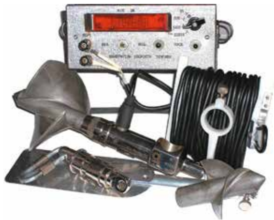
Рис. 1.82. Измеритель скорости течения ИСТ 1-0,06/120/70 с вертушкой (ВГ-1-120/70).
