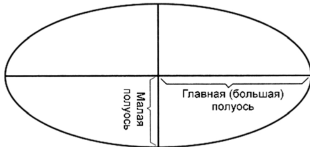
Рис. 1.65. Параметры эллиптической модели Земли
