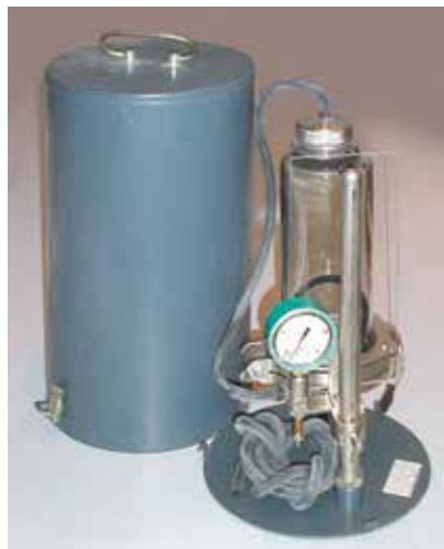
Рис. 1.94. Фильтровальный прибор Куприна ГР-60. Фото с сайта http://www.splyse.ru/offer/photo/1577/photo_1.html
