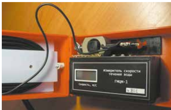
Рис. 1.84. Микровертушка ГМЦМ-1 в комплекте с кабелем и регистратором. Фото с сайта http://hydrotecpribor.ru
