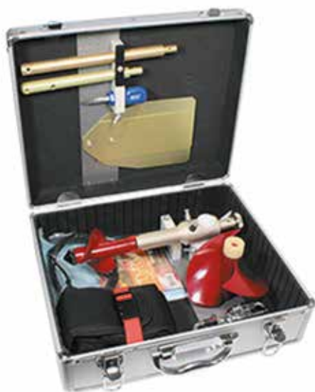
Рис. 1.83. Измеритель скорости потока ИСП-1М в упаковочном ящике. Фото с сайта http://www.анероид.рф/catalog/gidrologiya/mikrovertushki/isp-1m.htm
