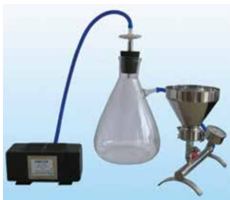
Рис. 1.95. Прибор вакуумного фильтрования ПВФ-47НБ. Фото с сайта http://medprom.ru/
