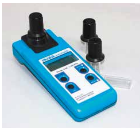
Рис. 1.96. Портативный микропроцессорный мутномер HI 93703 фирмы «Hanna», работающий в единицах мутности FTU. Фото с сайта http://www.eurolab.ru
