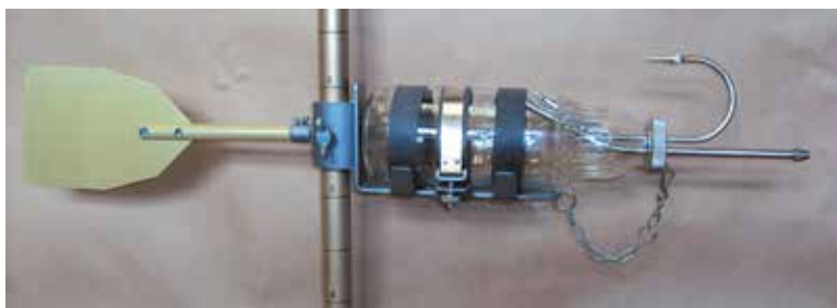
Рис. 1.93. Батометр-бутылка ГР-16М в сборе, установленный на штанге. Фото с сайта http://www.wikipip.ru/goods/32138806-batometr_gr_16m
