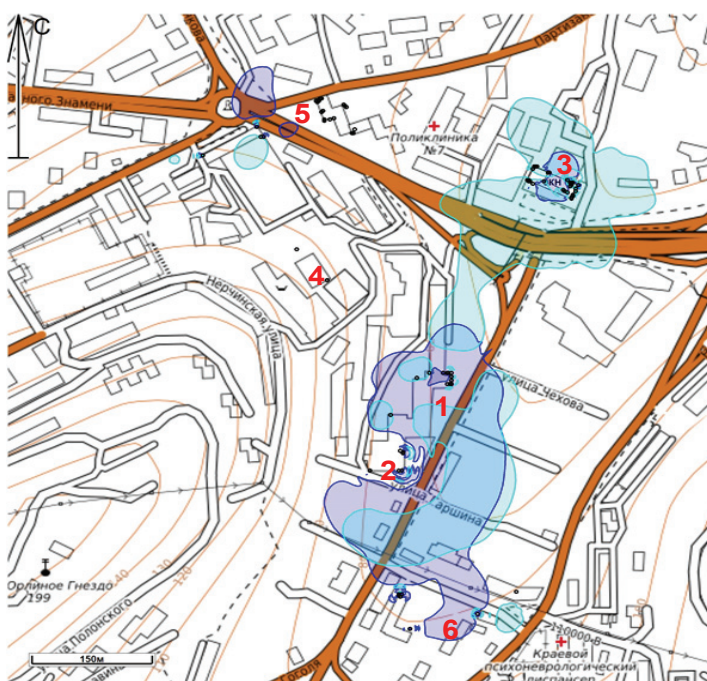
Рис. 1. Ситуационный план с расположением ПРТО и границами ЗОЗ от ПРТО без учета оборудования стандарта LTE, сечение на отметке, м: ■ – 80; ■ – 85
