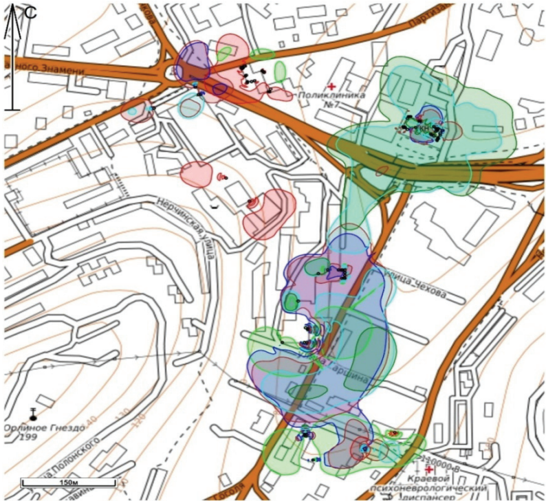
Рис. 2. Ситуационный план с границами ЗОЗ от ПРТО с учетом оборудования стандарта LTE, сечение на отметке, м: ■ – 76,4; ■ – 80; ■ – 83,1; ■ – 85; ■ – 92; ■ – 98,7
