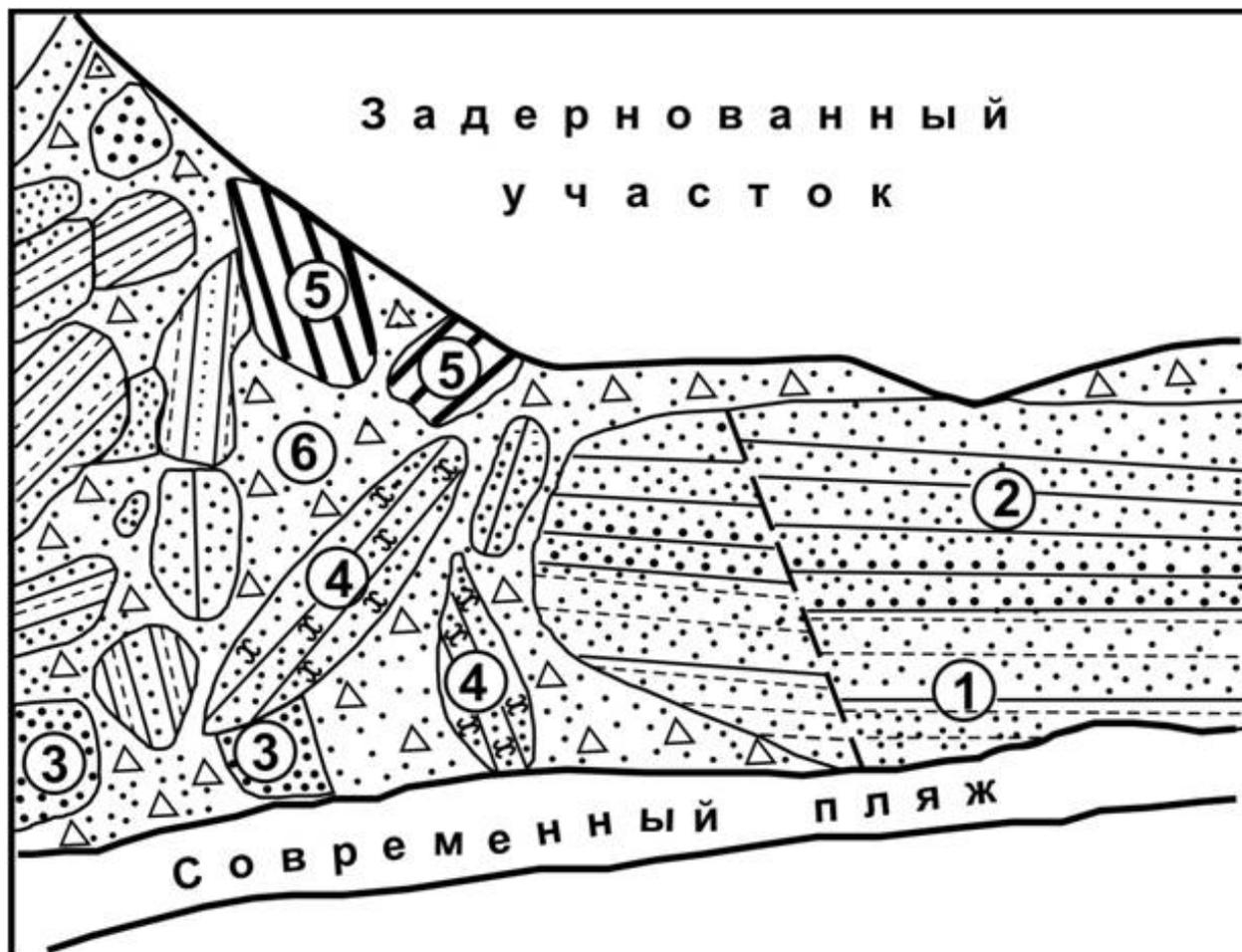
Рис. 4. Деталь строения гигантбрекчий: 1. – переслаивание туфоалевролитов и туфопесчаников; 2- переслаивание туфопесчаников и известковых туффитов; 3 – гравелиты; 4 – известковистые песчаники; 5 – туфоалевролиты и туфоаргиллиты; 6 – брекции [8].
