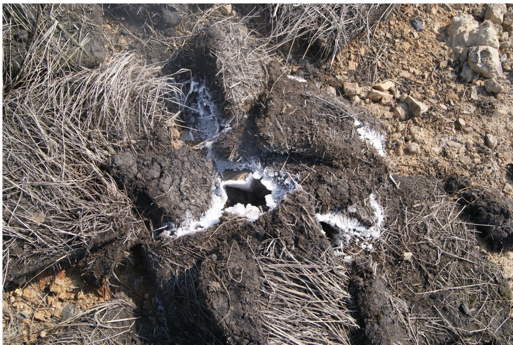
Рис. 13. Трещина на полигоне с выделением газа. температура 102 гр. С Fig. 13. Fission on the polygon with emission gas that have temperature 102° C
