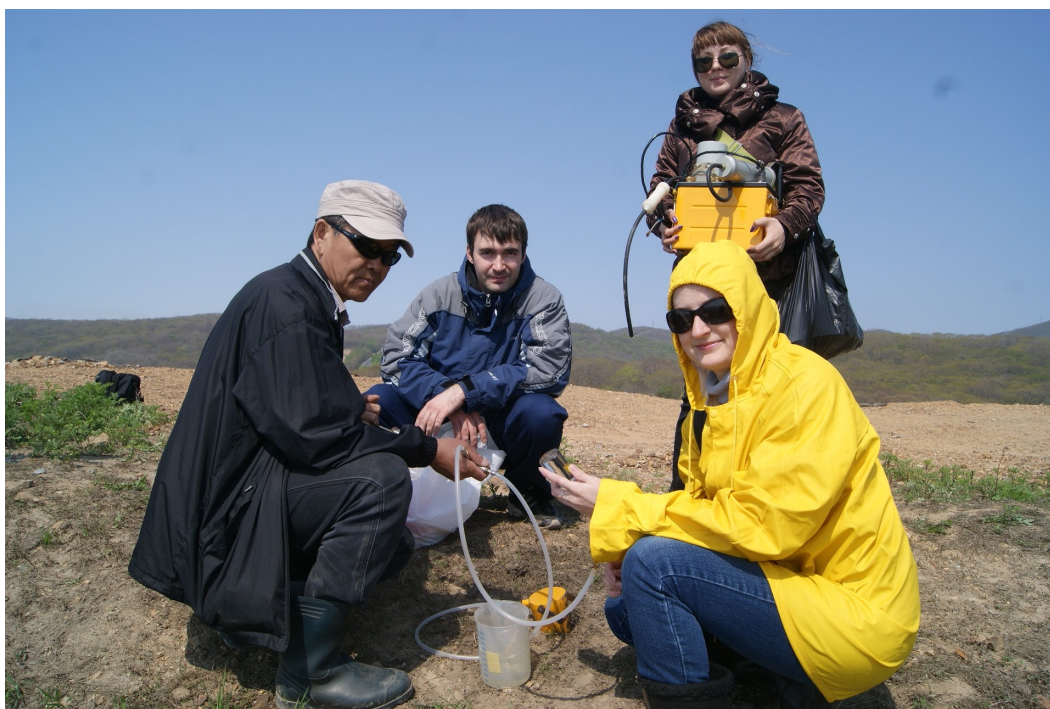
Рис. 12 Отбор газа на анализ из трещин, 2012 г Fig. 12. To take gas from degassing fission to analyse it, 2012.
