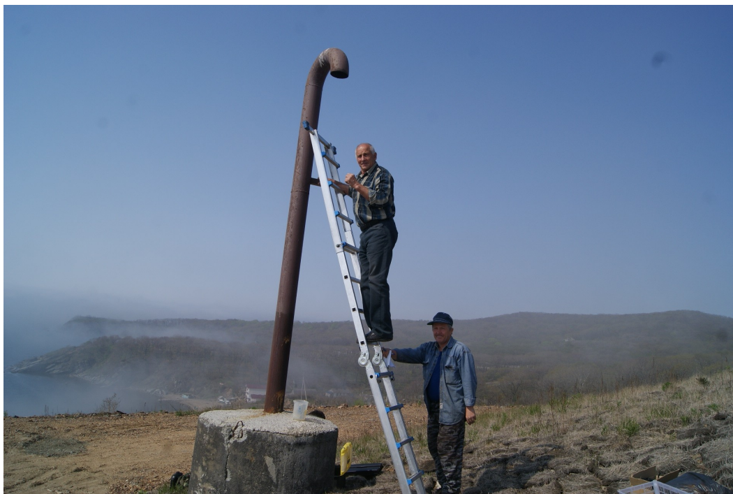
Рис. 11. Отбор газа на анализ из газодренажной скважины, 2012 Fig. 11. To take gas from degassing well to analyse it, 2012.
